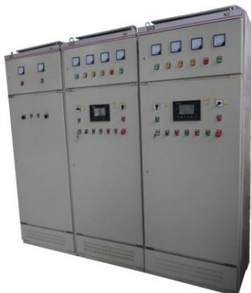
自动化并机机组控制屏通过对发电机组各种参数的采集以及机组之间的通讯,根据用户设置的值进行自动高速计算,对机组的电压、频率、相位角自动进行调整并达到同步、自动合闸并机。然后对机组及机组之间进行有功及无功功率管理和协调整套系统内机组加减控制。具有全自动全过程电脑数字控制,机组具有自动起动,自动同步并机、自动负载分配、并机自动装卸载、逆功保护、机组各种故障保护、负载过载保护、带有柔性加减负荷功能,减少对机组的冲击。
