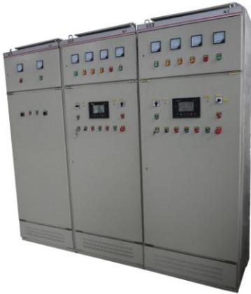
自动化并车机组控制屏通过对发电机组各种参数的采集以及机组之间的通讯,根据用户设置的值进行自动高速计算,对机组的电压、频率、相位角自动进行调整并达到同步、自动合闸并机。然后对机组及机组之间进行有功及无功功率管理和协调整套系统内机组加减控制。具有全自动全过程电脑数字控制,机组具有自动起动,自动同步并机、自动负载分配、并机自动装卸载、逆功保护、机组各种故障保护、负载过载保护、带有柔性加减负荷功能,减少对机组的冲击。
