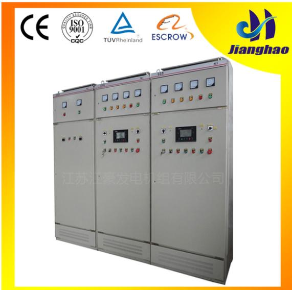
自动化并车机组控制屏通过对发电机组各种参数的采集以及机组之间的通讯,根据用户设置的值进行自动高速计算,对机组的电压、频率、相位角自动进行调整并达到同步、自动合闸并机。然后对机组及机组之间进行有功及无功功率管理和协调整套系统内机组加减控制。具有全自动全过程电脑数字控制,机组具有自动起动,自动同步并机、自动负载分配、并机自动装卸载、逆功保护、机组各种故障保护、负载过载保护、带有柔性加减负荷功能,减少对机组的冲击。
