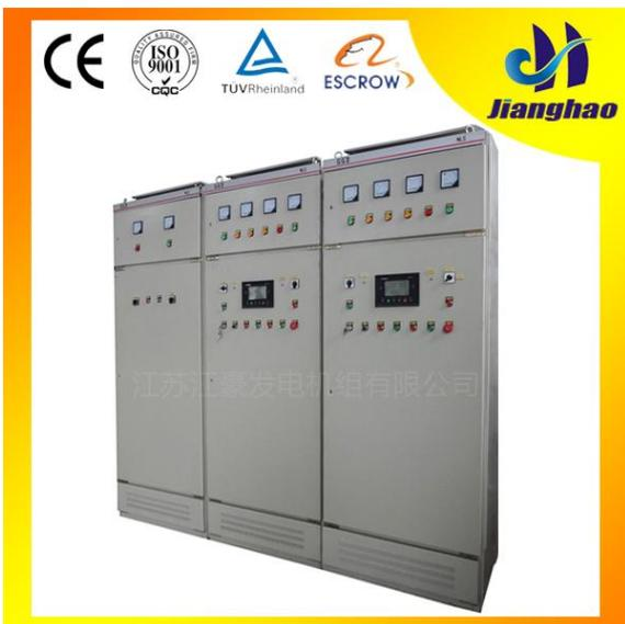
自动化并机机组控制屏通过对发电机组各种参数的采集以及机组之间的通讯,根据用户设置的值进行自动高速计算,对机组的电压、频率、相位角自动进行调整并达到同步、自动合闸并机。然后对机组及机组之间进行有功及无功功率管理和协调整套系统内机组加减控制。具有全自动全过程电脑数字控制,机组具有自动起动,自动同步并机、自动负载分配、并机自动装卸载、逆功保护、机组各种故障保护、负载过载保护、带有柔性加减负荷功能,减少对机组的冲击。
