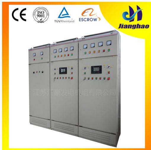
自动化并机机组控制屏通过对发电机组各种参数的采集以及机组之间的通讯,根据用户设置的值进行自动高速计算,对机组的电压、频率、相位角自动进行调整并达到同步、自动合闸并机。然后对机组及机组之间进行有功及无功功率管理和协调整套系统内机组加减控制。具有全自动全过程电脑数字控制,机组具有自动启动,自动同步并机、自动负载分配、并机自动装卸载、逆功保护、机组各种故障保护、负载过载保护、带有柔性加减负荷功能,减少对机组的冲击。
