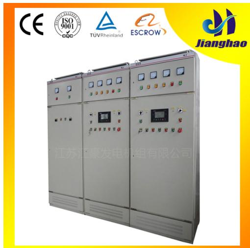
自动化并机组控制屏通过对发电机组各种参数的采集以及机组之间的通讯,根据用户设置的值进行自动高速计算,对机组的电压、频率、相位角自动进行调整并达到同步、自动合闸并机。然后对机组及机组之间进行有功及无功功率管理和协调整套系统内机组加减控制。具有全自动全过程电脑数字控制,机组具有自动起动,自动同步并机、自动负载分配、并机自动装卸载、逆功保护、机组各种故障保护、负载过载保护、带有柔性加减负荷功能,减少对机组的冲击。
